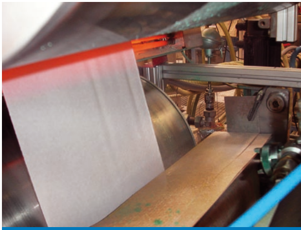
Abb. 3: Sprühen nach den Nasspressen – IR-Strahler aus Richtung Rückseite
