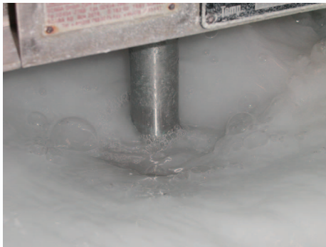
Schaum in den Büetten und am Stoffauslauf
