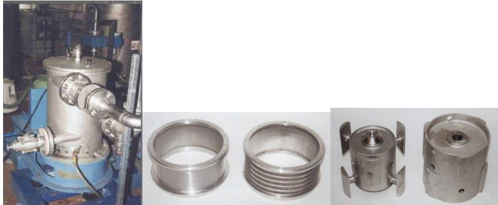
Abb. 3: Drucksortierer, Siebkorb und offener Foil-Rotor für Drucksortierer im PTS-Technikum
