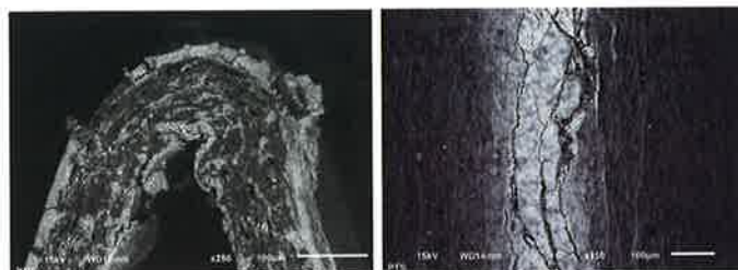
Abb. 6: Querschnitt und Draufsicht der Falzkante des konventionellen Schichtaufbaus. Fig. 6: Cross section and top view of folded edge of a paper with conventional layer structure.
